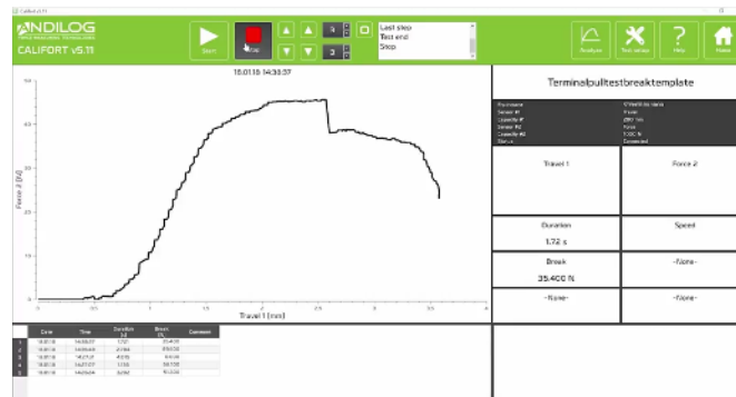
Exemple d'une mesure de force sur cosse jusqu'à la rupture
